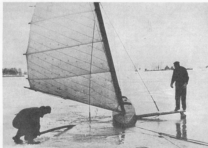
„Einbruch“ eines Eisseglers vor Starrischken. Auch mit Hebebaum und Talje war die Bergung schwierig. Mit einem kleinen Schlitten unter den Rumpf geschoben konnte man das Heck runterdrückend die Leekufe leichter anheben. Bild Walter
